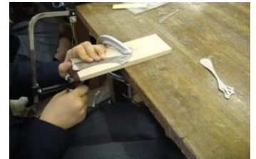
すり板を使用して手引き糸鋸で切る
