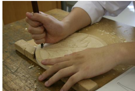
(2) 引くときは手の付け根を木の上に置き、そこを支点として指の握る力で切る。
